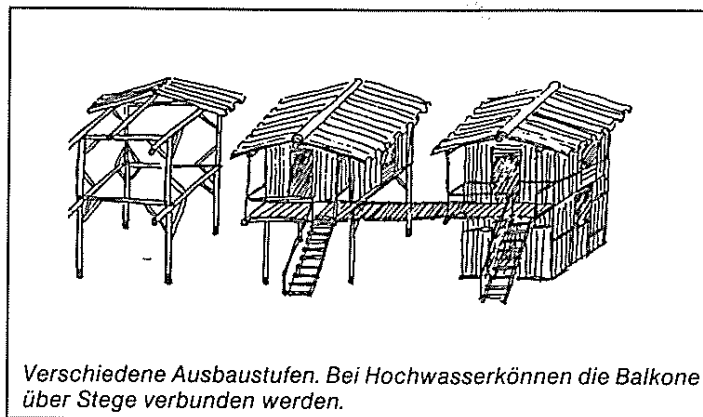
Prototyp des Hauses aus Palmholz für Überschwemmungen
